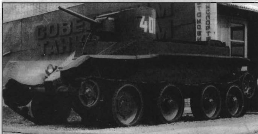
■ 37-мм пушка в башне легкого танка БТ-2
